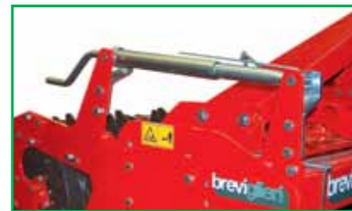
OPTION Mechanical jacks (2) 1 Martinetti meccanici (2) 2 Vérins mécaniques (2) 3 Mit Bolzen (2) 4 Con tornillos (2)
