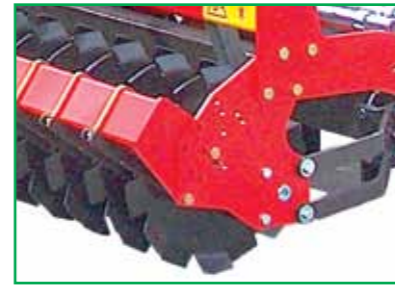
Crumbling roller (Ø 412-500) 1 Rullo sminuzzatore 2 Rouleau emoteur 3 Krummenpackerwalze 4 Rodillo desmenuzador
